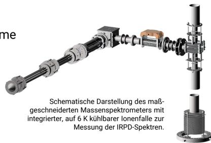
Schematische Darstellung des maßgeschneiderten Massenspektrometers mit integrierter, auf 6 K kühlbarer Ionenfalle zur Messung der IRPD-Spektren.
