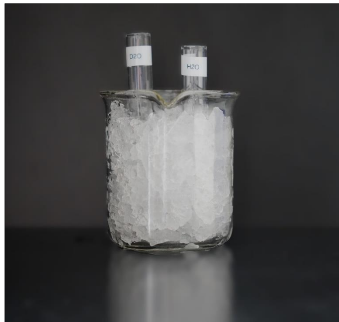
Abbildung 2: Experimentaufbau zur Untersuchung der Gefriertemperatur von D 2 O und H 2 O
