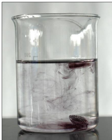
Abbildung 1: Beobachtungen zum Schwimm- bzw. Sinkverhalten von gefrorenem D 2 O und H 2 O
